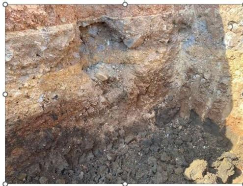
Ubicación de la calicata en la excavación exploratoria donde se detecta la capa vegetal
