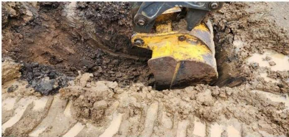
Material de subrasante que se detecta extensivamente a través del Proyecto y que consiste en una arcilla plástica, de baja resistencia al corte y con un potencial de expansión moderado a alto.
