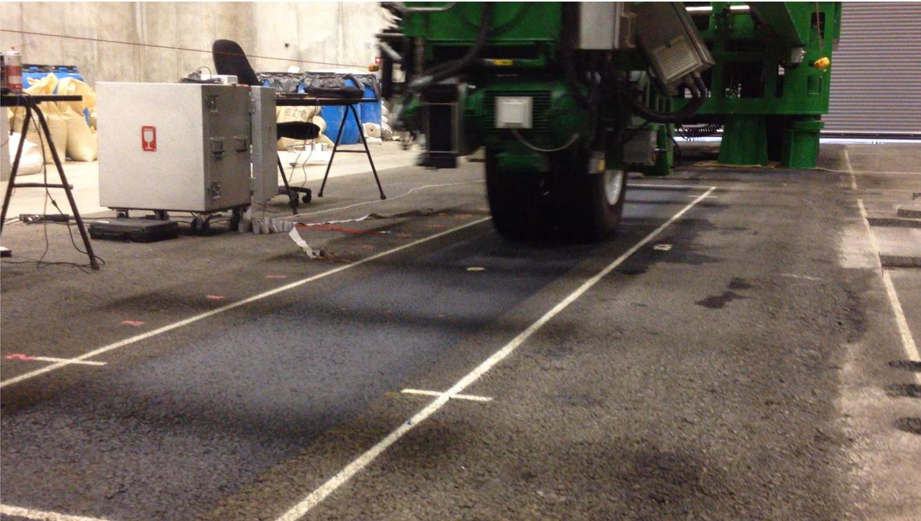
Un experimento de ensayos acelerados de pavimentos (APT) con un Heavy Vehicle Simulator (HVS) Mark VI-Dynatest
