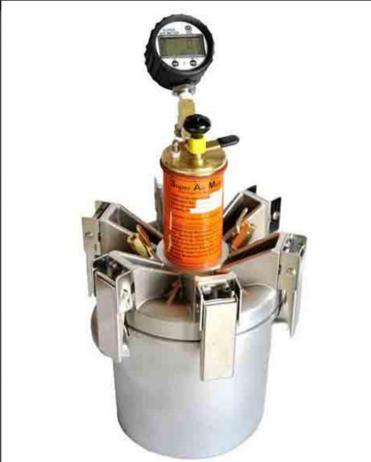
The Super Air Meter (SAM) Pruebas no sólo del contenido de aire, sino también de la estructura y calidad del aire
