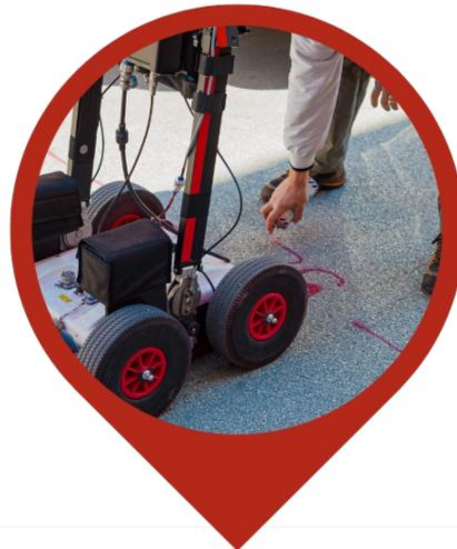
La antena de GPR emite un pulso de energía electromagnética que se encuentra en el rango de frecuencias de radio. A veces se la denomina onda de radio.
