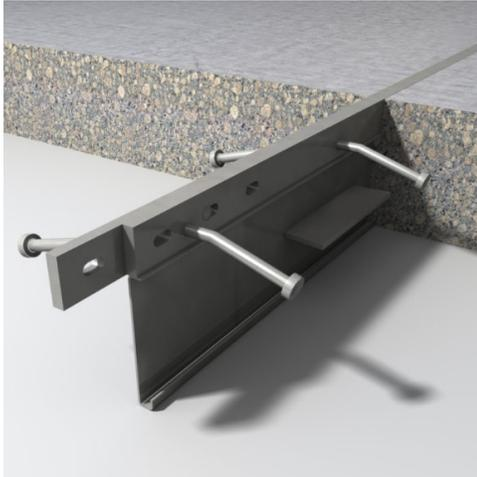
Otro verdadero avance fue la introducción en el mercado de las famosas perfiles blindados (**juntas metálicas**) que protegían las juntas de construcción y que garantizaban el traspaso de cargas de unas losas a otras mediante la inclusión de los **dowels en forma de diamante o trapezoidales**, los cuales permitían el doble movimiento de las juntas. Con ello se desplazó al uso de barras como forma de traspaso de cargas.
