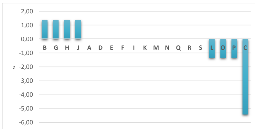
Gráfico 5-3. Puntaje z para el ensayo de temperatura del concreto.
