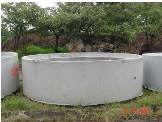
Fotografía 16. Tubería de concreto empleada
